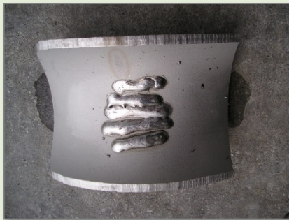
溶接焼けの除去
