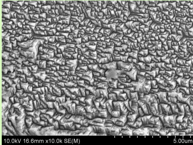
「ラストスイーパー®」処理後(新化成処理) (リン酸鉄処理)
